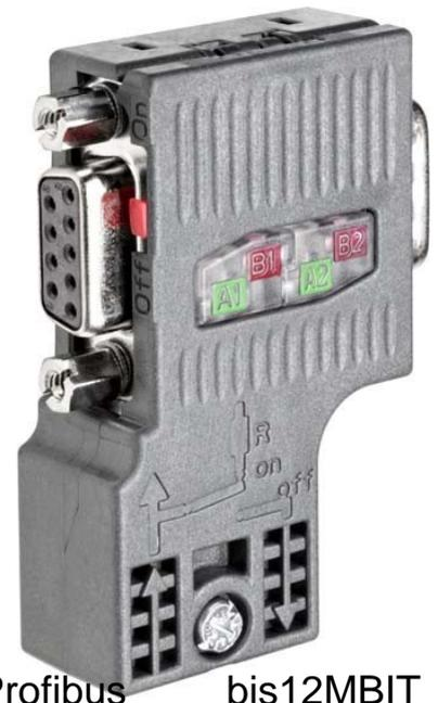
Siemens Indus.Sector Anschlußstecker F.Profibus bis12MBIT 6ES7972-0BB52-0XA0 Art des elektrischen Zubehörs Stecker, Art des mechanischen Zubehörs sonstige, Art der Dokumentation sonstige, SIMATIC DP, Anschlussstecker für PROFIBUS bis 12 MBit/S 90 Grad Kabelabgang, 15,8x59x35,6mm (BxHxT), Schneidklemmtechnik Fast Connect, mit PG-Buchse
