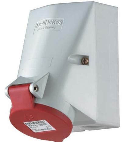
Mennekes Wanddose TwinCONTACT 32A,5p,6h,400V,IP44 422 Ausführung Aufputz, IEC-Stromstärke 32A, Polzahl 5, Spannung nach EN 60309-2 400 V (50+60 Hz) rot, Uhrzeit-Stellung 6h, Kennfarbe rot, Schutzart (IP) IP44, Anschlussstechnik schraublose Klemme, Werkstoff Kunststoff, Befestigungsart innenliegende Befestigung,
