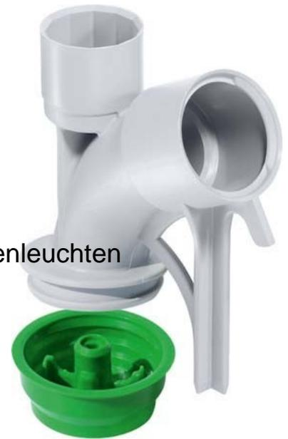
Kaiser Krümmer f.DIN EN Rohr 25 1202-34 Ausführung der Leitung Rohr, Montageart Beton, Anzahl der Einführungen 1, Auslasslänge 72mm, Auslassbreite 35mm, Auslassdurchmesser 25mm, Wand- und Deckenkrümmer 30° für DIN EN Rohr Außen-Ø 25,0 mm, Einbauhöhe 62 mm, zum Verbinden von Rohren oder als Deckenauslass, zur Schalungsseite mit Putzhaut verschlossen, halogenfrei
