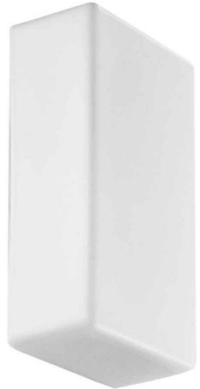
RZB Zimmermann Ersatzglas opal-mt 220x120mm 05-21136 Art des Zubehörs Abdeckung, Werkstoff Glas, Länge 220mm, Breite 120mm, Höhe/Tiefe 82mm, Beschaffenheit der Abdeckung opal, Ersatzglas opal seidenmatt, mundgeblasen, Befestigung durch Federsystem
