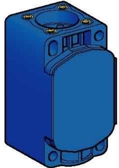
Schneider Electric Unterteil SÖ tropenfest ZCKS1 Breite des Sensors 40mm, Höhe des Sensors 72,5mm, Schaltfunktion Sprungschaltglied, Anzahl der sicherheitsgerichteten Hilfskontakte 0, Anzahl der Kontakte als Öffner 1, Anzahl der Kontakte als Schließer 1, Anzahl der Kontakte als Wechsler 0, Werkstoff des Gehäuses Kunststoff, Beschichtung Gehäuse anodisiert/eloxiert, Geeignet für Sicherheitsfunktionen, Gehäuse für 2polige Hilfsschalter, kunststoffgekapselt, schutzisoliert.
