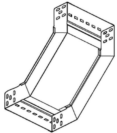
Niedax Rinnensteigbogen RSD 110.300 Richtungsänderung vertikal steigend, Abbiegung (Winkel) 90°, Kabelrinnenhöhe 110mm, Kabelrinnenbreite 300mm, Ausführung integrierter Verbinder, Werkstoff Stahl, Werkstoffgüte sonstige, Oberfläche bandverzinkt, Farbe ohne, Steigstück 2x um 45° gebogen
