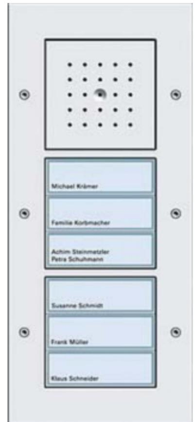
Gira Türstation AP 6fach reinweiß 126866 Mit Infoschild, Anzahl der Ruftasten 6, Montageart Aufputz, Mit Abdeckung, Schutz gegen Vandalismus, Modulare Bauweise, Farbe weiß, Installationstechnik Bus-System, Türstation mit Türlautsprecher und Ruftaster als komplett vormontierte Einheit für die senkrechte Aufputz Montage.
