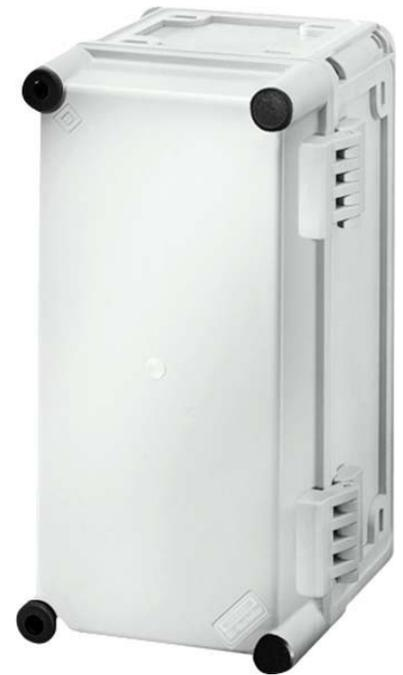
Hensel Mi-Einzelleergehäuse 275x125x146mm Mi 9101 Höhe 300mm, Breite 165mm, Tiefe 170mm, Einbautiefe 146mm, RAL-Nummer 7035, Werkstoff des Gehäuses Kunststoff, Oberfläche ohne, Schutzart (IP) IP65, Leitungseinführung, Art des Deckels geschlossen, Leergehäuse zur Einzelmontage mit scharniertem Deckel.
