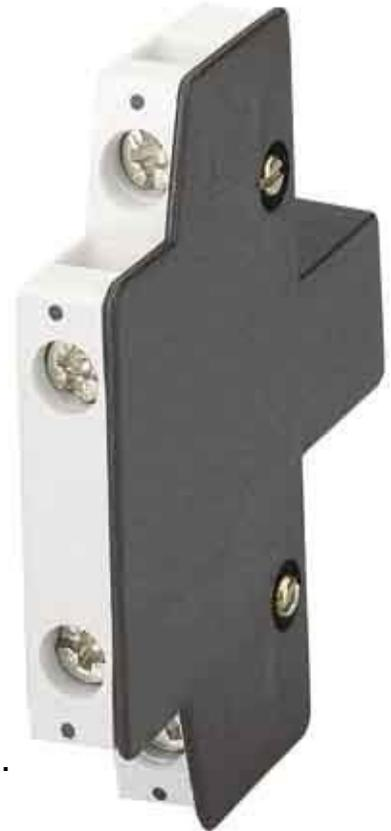
DILM820-XHI11-SI Anzahl der Kontakte als Wechsler 0, Anzahl der Kontakte als Schließer 1, Anzahl der Kontakte als Öffner 1, Bemessungsbetriebsstrom I<sub>e</sub> bei AC-15, 230 V 6A, Ausführung des elektrischen Anschlusses Schraubanschluss, Montageart Seitenanbau, Hilfsschalterbaustein 2-polig, seitlich Innen anbaubar, mit Schraubklemmen, mit zwangsgeführten Kontakten, verwendbar für Leistungsschutz DILM250; DILM1600 und DILH1400; 2600
