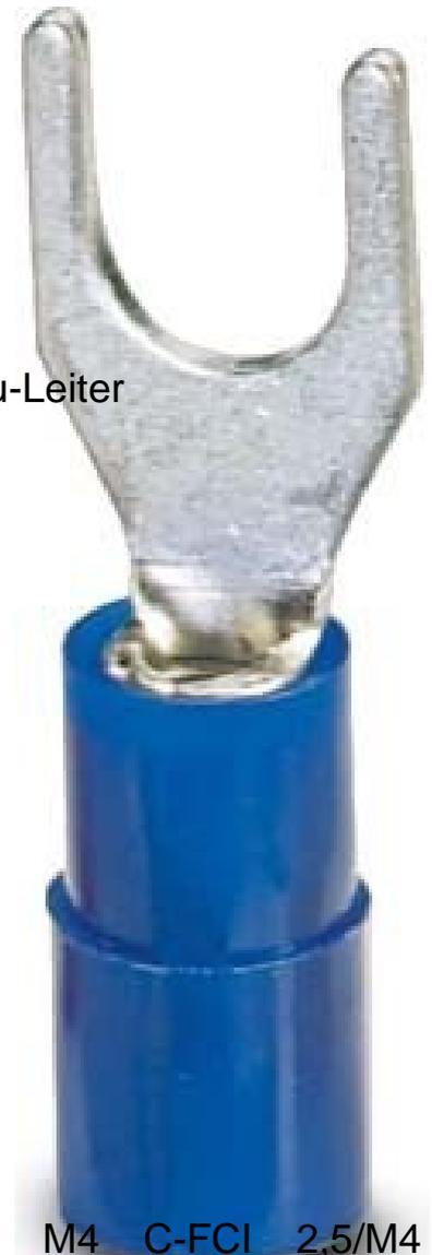
Phoenix Contact Gabelkabelschuh bl, 1,5-2,5qmm, M4 C-FCI 2,5/M4 Anschlussgewindemaß metrisch 4, Flanschform Gabelform, Nach DIN, Isolation PA, Farbe der Isolation blau, Nennquerschnitt 1,5 ...
