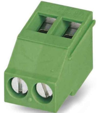
Phoenix Contact Leiterplattenklemme MKDSF 3/ 2 Höhe 11,2mm, Anzahl der elektrischen Anschlüsse 2, Anzahl der Etagen 1, Rastermaß der Anschlüsse 5mm, Winkel Leiterplatte/Leiteranschluss 90° (vertikal nach oben),
