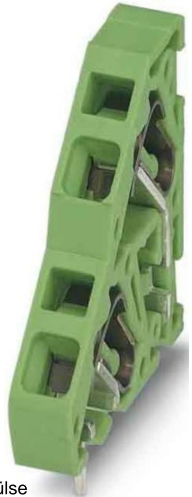
Phoenix Contact Leiterplattenklemme ZFKKDS 2,5-5,08 L Höhe 25,5mm, Anzahl der elektrischen Anschlüsse 1, Anzahl der Etagen 2, Rastermaß der Anschlüsse 5,08mm, Winkel Leiterplatte/Leiteranschluss 45°/135° (schräg nach oben),
