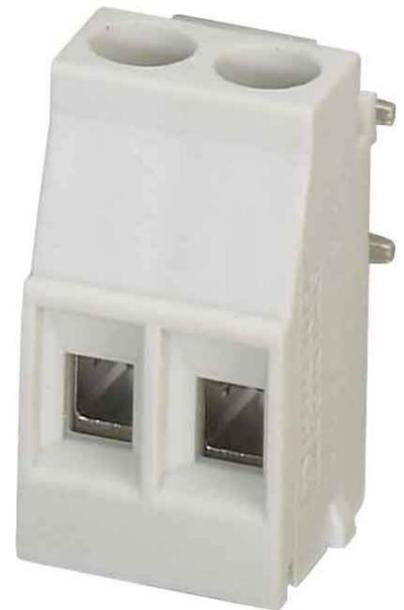
Phoenix Contact COMBICON Leiterplattenstec kverbinder MKDSO 2,5/ 2-R KMGY Anzahl der elektrischen Anschlüsse 2, Anzahl der Etagen 1, Rastermaß der Anschlüsse 5mm, Winkel Leiterplatte/Leiteranschluss 0°/180° (horizontal), Bemessungsstrom In 24A, Bemessungsspannung 320V, Bemessungsstoßspannung 4kV, Überspannungskategorie III, Verschmutzungsgrad 2, Anschlussart Leiter Schraubanschluss, Anschließbarer Leiterquerschnitt eindrätig 0,14 ...
