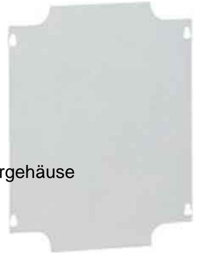
Legrand (BT) Montageplatte 35090 Höhe 212mm, Breite 154mm, Werkstoff Stahl, Oberfläche verzinkt,
