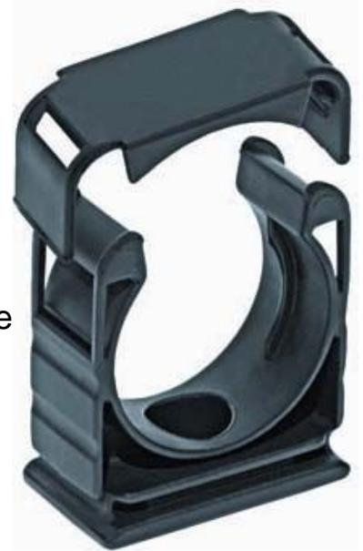
Flexa Schlauchhalter Kunststoff RQH-G AD 42,5gr Werkstoff Kunststoff, Werkstoffgüte Polyamid (PA), Nenndurchmesser 42,5mm, Farbe grau, Befestigungsart Schraubloch, Schlauchhalter mit Deckel mit Durchgangsloch zur Befestigung mittels Schrauben, Rippenfixierung zur Zugentlastung, unterschiedliche Größen aneinanderreihbar, einsetzbar in C-Profilschienen
