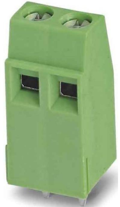
Phoenix Contact Mehrpoliger Print-Klemmenblock MKKDSNH 1,5/ 2-5,08 Höhe 19,1mm, Anzahl der elektrischen Anschlüsse 2, Anzahl der Etagen 1, Rastermaß der Anschlüsse 5,08mm, Winkel Leiterplatte/Leiteranschluss 0°/180° (horizontal),
