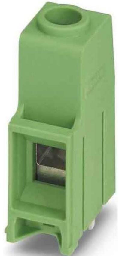
Phoenix Contact Print-Einzelklemme MKDS 10 HV/ #1993776 Höhe 31mm, Anzahl der elektrischen Anschlüsse 1, Anzahl der Etagen 1, Rastermaß der Anschlüsse 10,16mm, Winkel Leiterplatte/Leiteranschluss 0°/180° (horizontal),
