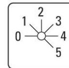
Eaton (Moeller) Stufenschalter T0-3-144/EZ Ausführung des Schalters Stufenschalter, Polzahl 1, Max.
