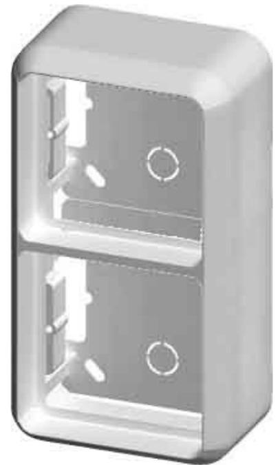
Elso AP-Gehäuse gr 2-fach 234211 Zusammenstellung Aufputzgehäuse, Geeignet für modulare Installationsschalterprogramme, Anzahl der Module (bei Modulbauweise) 0, Gerätetiefe 47,5mm, Anzahl der Einheiten 2, Montagerichtung horizontal und vertikal, Werkstoff Kunststoff, Werkstoffgüte Thermoplast, Halogenfrei, Oberfläche unbehandelt, Ausführung der Oberfläche glänzend,
