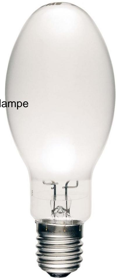
Havells Sylvania Hochdrucklampe E40 SHP-S 250W Lampenleistung 255W, Lichtstrom 30000lm, Socket E40, Lampenform ellipsoid, Farbwiedergabestufe 20-39 (Klasse 4), Farbtemperatur 2050K, Externes Zündgerät erforderlich, Externes Vorschaltgerät erforderlich, Gesamtlänge 227mm, Durchmesser 91mm, Anzahl der Brenner 1, Ausführung matt,
