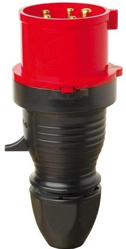
Walther Werke Stecker schwarz 32A 5P 400V 6h IP44 230SW IEC-Stromstärke 32A, UL/CSA-Stromstärke (wenn UL-Ausführung gewünscht) 30A, Polzahl 5, Spannung nach EN 60309-2 400 V (50+60 Hz) rot, Uhrzeit-Stellung 6h, Kennfarbe rot, Schutzart (IP) IP44, Anschlussstechnik Schraubklemme, Kabeleinführung Knickschutztülle, Steckrichtung gerade, Werkstoff Kunststoff, Stecker schwarz 32A 5P 400V 6h IP44 mit Kabelknickschutz
