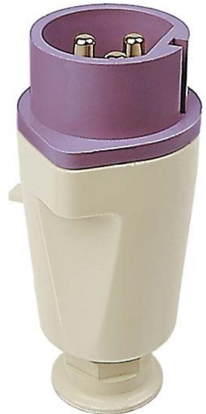
Walther Werke NORVO Stecker 32A 2P 42V 3h IP44 11214 IEC-Stromstärke 32A, UL/CSA-Stromstärke (wenn UL-Ausführung gewünscht) 30A, Polzahl 2, Spannung nach EN 60309-2 20-25 V / 40-50 V (400 Hz) grün, Uhrzeit-Stellung 3h, Kennfarbe grün, RAL-Nummer 6025, Schutzart (IP) IP44, Anschlussstechnik Schraubklemme, Kabeleinführung Verschraubung, Steckrichtung gerade, Werkstoff Kunststoff, NORVO Stecker 32A 2P 42V 3h IP44 mit Trompetenverschraubung
