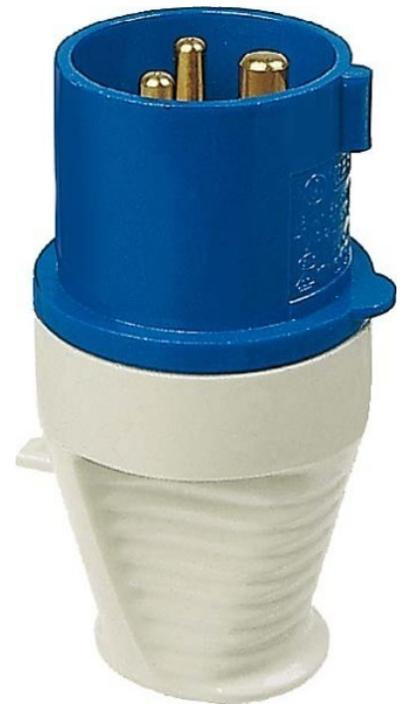
Walther Werke Stecker 16A 3P 400V 9h IP44 215309 IEC-Stromstärke 16A, UL/CSA-Stromstärke (wenn UL-Ausführung gewünscht) 20A, Polzahl 3, Spannung nach EN 60309-2 400 V (50+60 Hz) rot, Uhrzeit-Stellung 9h, Kennfarbe rot, RAL-Nummer 3000, Schutzart (IP) IP44, Anschlussstechnik Schraubklemme, Kabeleinführung Knickschutztülle, Steckrichtung gerade, Werkstoff Kunststoff, Stecker 16A 3P 400V 9h IP44 mit innenliegendem Kabelknickschutz
