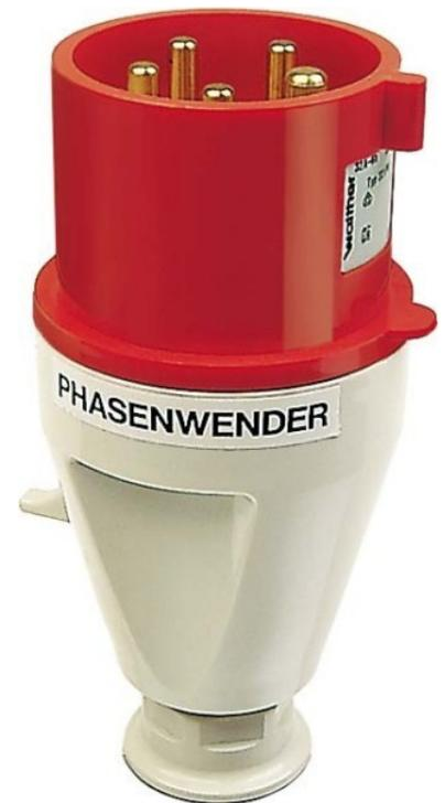
Walther Werke Phasenwender Stecker 32A 5P 400V 6h IP44 231PHNI IEC-Stromstärke 32A, UL/CSA-Stromstärke (wenn UL-Ausführung gewünscht) 30A, Polzahl 5, Spannung nach EN 60309-2 400 V (50+60 Hz) rot, Uhrzeit-Stellung 6h, Kennfarbe rot, RAL-Nummer 3000, Phasenwender, Schutzart (IP) IP44, Anschlussstechnik Schraubklemme, Kabeleinführung Verschraubung, Steckrichtung gerade, Werkstoff Kunststoff, Phasenwender Stecker 32A 5P 400V 6h IP44 mit Trompeten-verschraubung
