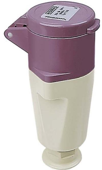
Walther Werke NORVO Kupplung 16A 2P 42V 10h IP44 10315 IEC-Stromstärke 16A, UL/CSA-Stromstärke (wenn UL-Ausführung gewünscht) 20A, Polzahl 2, Spannung nach EN 60309-2 20-25 V / 40-50 V (>400-500 Hz) grün, Uhrzeit-Stellung 10h, Kennfarbe grün, RAL-Nummer 6025, Schutzart (IP) IP44, Anschluss technik Schraubklemme, Steckrichtung gerade, Kabeleinführung Verschraubung, Werkstoff Kunststoff, NORVO Kupplung 16A 2P 42V 10h IP44 mit Trompeten- verschraubung
