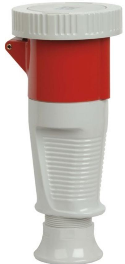
Walther Werke Kupplung 63A 5P 230V 9h IP67 369509 IEC-Stromstärke 63A, UL/CSA-Stromstärke (wenn UL-Ausführung gewünscht) 60A, Polzahl 5, Spannung nach EN 60309-2 230 V (50+60 Hz) blau, Uhrzeit-Stellung 9h, Kennfarbe blau, RAL-Nummer 5002, Schutzart (IP) IP67, Anschlussstechnik Schraubklemme, Steckrichtung gerade, Kabeleinführung Verschraubung, Werkstoff Kunststoff, Kupplung 63A 5P 230V 9h IP67 mit Trompetenverschraubung
