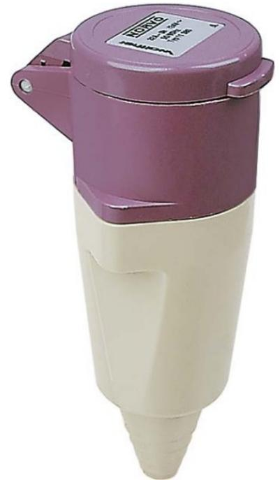
Walther Werke NORVO Kupplung 16A 3P 42V 3h IP44 10394 IEC-Stromstärke 16A, UL/CSA-Stromstärke (wenn UL-Ausführung gewünscht) 20A, Polzahl 3, Spannung nach EN 60309-2 20-25 V / 40-50 V (400 Hz) grün, Uhrzeit-Stellung 3h, Kennfarbe grün, RAL-Nummer 6025, Schutzart (IP) IP44, Anschlussstechnik Schraubklemme, Steckrichtung gerade, Kabeleinführung Knickschutztüle, Werkstoff Kunststoff, NORVO Kupplung 16A 3P 42V 3h IP44 mit Kabelknickschutz
