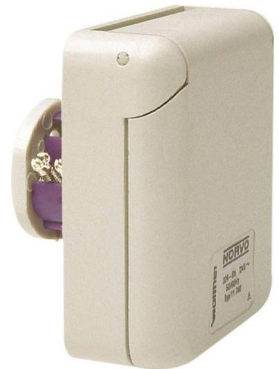
Walther Werke MONDO Anbaudose 16A 2P 42V 4h IP44 10702 IEC-Stromstärke 16A, Polzahl 2, Spannung nach EN 60309-2 20-25 V / 40-50 V (100-200 Hz) grün, Uhrzeit-Stellung 4h, Kennfarbe grün, Schutzart (IP) IP44, Anschlussstechnik Schraubklemme, Steckrichtung gerade, Werkstoff Kunststoff, MONDO Anbaudose 16A 2P 42V 4h IP44 Kanalinstallation
