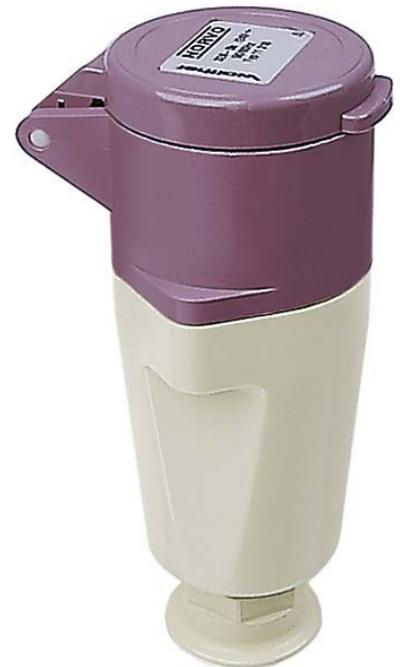
Walther Werke NORVO Kupplung 32A 2P 42V 3h IP44 11314 IEC-Stromstärke 32A, UL/CSA-Stromstärke (wenn UL-Ausführung gewünscht) 30A, Polzahl 2, Spannung nach EN 60309-2 20-25 V / 40-50 V (400 Hz) grün, Uhrzeit-Stellung 3h, Kennfarbe grün, RAL-Nummer 6025, Schutzart (IP) IP44, Anschlussstechnik Schraubklemme, Steckrichtung gerade, Kabeleinführung Verschraubung, Werkstoff Kunststoff, NORVO Kupplung 32A 2P 42V 3h IP44 mit Trompetenverschraubung
