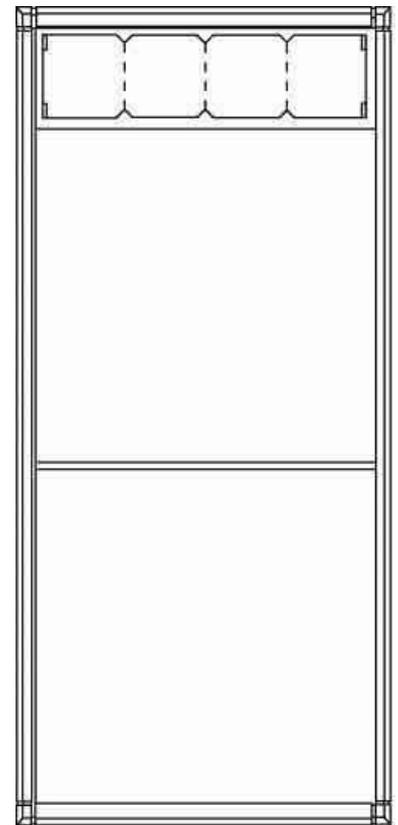
Ritto Portier Gehäuse UP 2fach weiss 1552370 Werkstoff Stahlblech, Montageart Unterputz, Anzahl der Klingeltasten 0, Anzahl der Briefkästen 2, Anzahl der Modulplätze 4, Farbe weiß, Höhe 940mm, Breite 403,5mm, Tiefe 145mm, Abmessungen : 419,5x961x145 mm (BxHxT).
