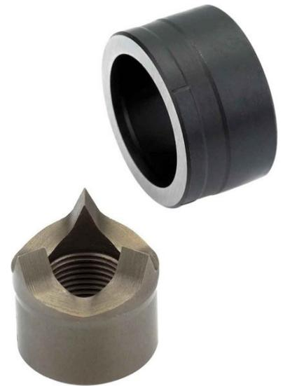
Cimco Schraublocher Pg42 V2A 13 2728 Lochform rund, Lochdurchmesser PG42, Lochdurchmesser 54mm, Zu bearbeitender Werkstoff rostfreier Stahl (V2A), Ausführung Matrize und Stempel, Betätigungsart hydraulisch, Betätigungsart mechanisch, Spaltlocher, Schraublocher DIAMANT ? VA Innovativer Spalt-Stempel mit drei Schneidspitzen: Stanzabfall wird in drei Teile gespalten. Geeignet für: Edelstahl (VA), Stahlblech (ST 37), Kunststoff und Aluminium.
