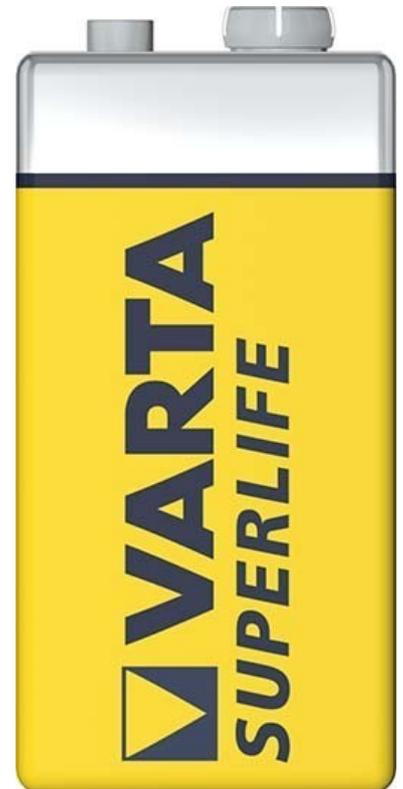
Varta Cons.Varta Batterie 9V/6F22 Superlife 9V 2022 Fol.1 Größenbezeichnung Block, Anzahl der Zellen 6, Ausführung Zink/Kohle, Nennspannung 9V, Kapazität 380mAh, IEC-Bezeichnung 6 F 22, Sonstige Bezeichnung ohne, Länge 26,5mm, Höhe inkl.
