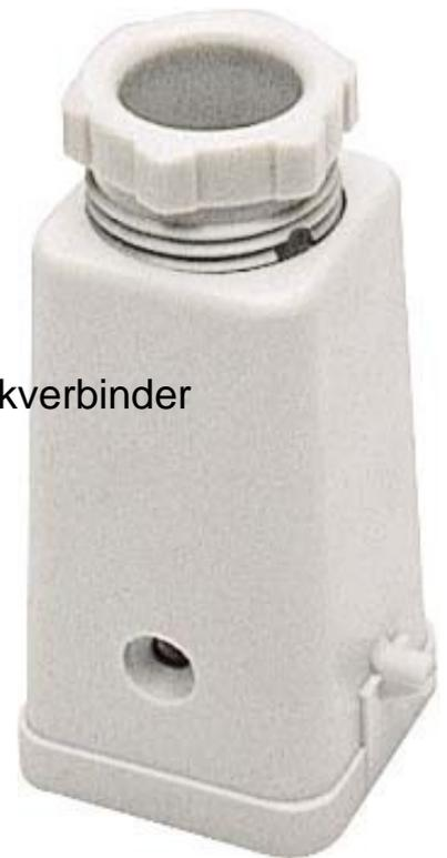
Walther Werke Tüllengehäuse A3/A4 H=57mm M20 LVN T700625MS Form rechteckig, Länge 26,5mm, Höhe 57mm, Breite 26,5mm, Ausführung des Gehäuses sonstige, Anordnung der Kabelzuführung oben, Bügellage ohne, Werkstoff des Gehäuses Kunststoff, Beschichtung Gehäuse unbeschichtet, Mit Verriegelungsvorrichtung, Art der Verriegelung Längsbügel, Brennbarkeitsklasse des Isolierstoffs nach UL 94 V0, Betriebstemperatur -40 ...
