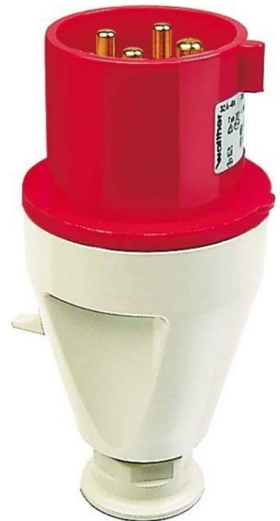
Walther Werke Stecker 32A 4P 400V 6h IP44 231406 IEC-Stromstärke 32A, UL/CSA-Stromstärke (wenn UL-Ausführung gewünscht) 30A, Polzahl 4, Spannung nach EN 60309-2 400 V (50+60 Hz) rot, Uhrzeit-Stellung 6h, Kennfarbe rot, RAL-Nummer 3000, Schutzart (IP) IP44, Anschlussstechnik Schraubklemme, Kabeleinführung Verschraubung, Steckrichtung gerade, Werkstoff Kunststoff, Stecker 32A 4P 400V 6h IP44 mit Trompetenverschraubung
