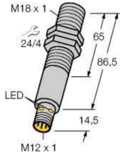
Turck Ultraschallsensor Reflexionstaster RU30-M18-LIX-H1141 Ausführung des Analogausgangs 4 mA ...
