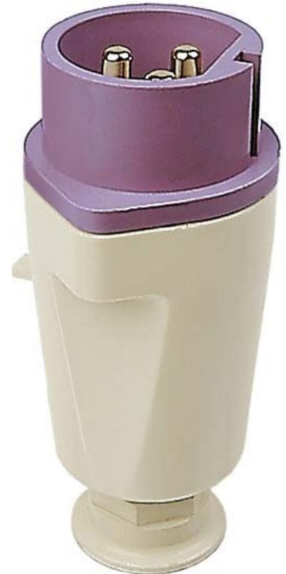
Walther Werke NORVO Stecker 32A 3P 42V 11h IP44 11255 IEC-Stromstärke 32A, UL/CSA-Stromstärke (wenn UL-Ausführung gewünscht) 30A, Polzahl 3, Spannung nach EN 60309-2 20-25 V / 40-50 V (>400-500 Hz) grün, Uhrzeit-Stellung 11h, Kennfarbe grün, RAL-Nummer 6025, Schutzart (IP) IP44, Anschlussstechnik Schraubklemme, Kabeleinführung Verschraubung, Steckrichtung gerade, Werkstoff Kunststoff, NORVO Stecker 32A 3P 42V 11h IP44 mit Trompeten- verschraubung
