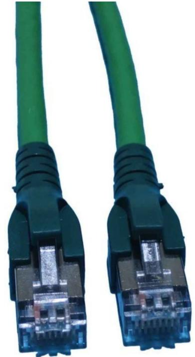
CommScope/AMP Netconn Patchkabel Kat.6A S/FTP RJ45/RJ45, grün TN-6000A gn 30,0m Kabeltyp S/FTP, Kategorie 6A (IEC), Länge 30m, Steckverbindertyp Anschluss 1 RJ45 8(8), Steckverbindertyp Anschluss 2 RJ45 8(8), Mantel-Farbe grün, Knickschutztülle angespritzt, Rasthebelschutz, Farbe der Knickschutztülle grün, Ausführung flammwidrig, Halogenfrei, Kabelkonstruktion 4x2, AWG-Querschnitt 27, Pinbelegung 1:1, Die Kat.
