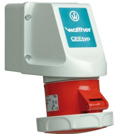
Walther Werke Wandsteckdose 16A 4P 500V 7h IP67 119407 Ausführung Aufputz, IEC-Stromstärke 16A, UL/CSA-Stromstärke (wenn UL-Ausführung gewünscht) 20A, Polzahl 4, Spannung nach EN 60309-2 500 V (50+60 Hz) schwarz, Uhrzeit-Stellung 7h, Kennfarbe schwarz, RAL-Nummer 9005, Schutzart (IP) IP67, Anschlussstechnik Schraubklemme, Kabeleinführung sonstige, Werkstoff Kunststoff, Befestigungsart innenliegende Befestigung, Isolierter Einbau, Wandsteckdose 16A 4P 500V 7h IP67 Innenbefestigung 2 Kabeleinf.
