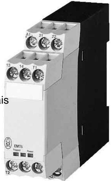
Eaton (Moeller) Motorschutzrelais 6A,24-240V 50-60Hz EMT6 Anzahl der Messkreise 1, Anzahl der Kontakte als Öffner 1, Anzahl der Kontakte als Schließer 1, Anzahl der Kontakte als Wechsler 0, Anschlussart Hilfsstromkreis Schraubanschluss, Bemessungssteuerspeisespannung  $U_s$  24 ...
