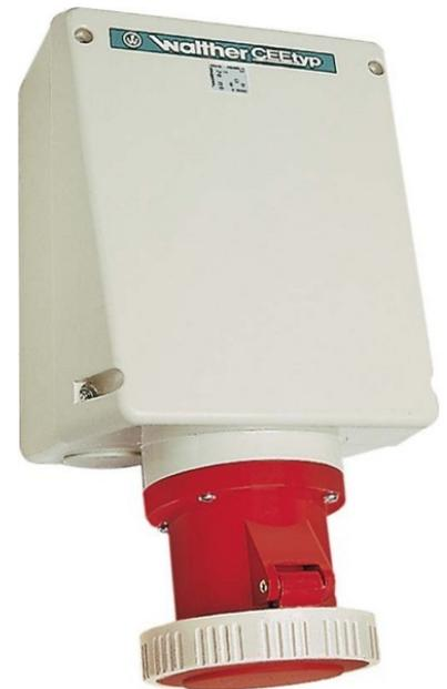
Walther Werke Wandsteckdose 125A 5P 400V 6h IP67 179NI Ausführung Aufputz, IEC-Stromstärke 125A, Polzahl 5, Spannung nach EN 60309-2 400 V (50+60 Hz) rot, Uhrzeit-Stellung 6h, Kennfarbe rot, Schutzart (IP) IP67, Anschlussstechnik Schraubklemme, Werkstoff Kunststoff, Befestigungsart innenliegende Befestigung, Wandsteckdose 125A 5P 400V 6h IP67 Innenbefestigung 1xM50 und 1xM20 oben
