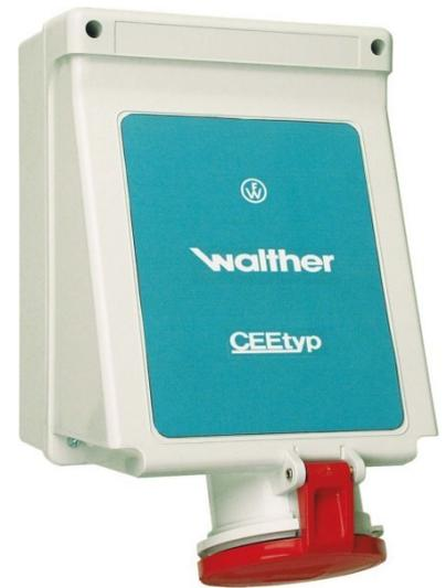
Walther Werke Wandsteckdose 63A 4P >50-500V 10h IP44 163410 Ausführung Aufputz, IEC-Stromstärke 63A, UL/CSA-Stromstärke (wenn UL-Ausführung gewünscht) 60A, Polzahl 4, Spannung nach EN 60309-2 50-500 V (100-300 Hz) grün, Uhrzeit-Stellung 10h, Kennfarbe grün, RAL-Nummer 6025, Schutzart (IP) IP44, Anschlussstechnik Schraubklemme, Kabeleinführung sonstige, Werkstoff Kunststoff, Befestigungsart innenliegende Befestigung, Isolierter Einbau, Wandsteckdose 63A 4P >50-500V 100-300Hz 10h IP44 2 Kabeleinf.
