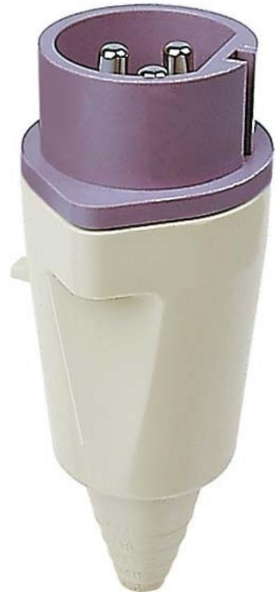
Walther Werke NORVO Stecker 32A 2P 42V 3h IP44 11284 IEC-Stromstärke 32A, UL/CSA-Stromstärke (wenn UL-Ausführung gewünscht) 30A, Polzahl 2, Spannung nach EN 60309-2 20-25 V / 40-50 V (400 Hz) grün, Uhrzeit-Stellung 3h, Kennfarbe grün, RAL-Nummer 6025, Schutzart (IP) IP44, Anschlussstechnik Schraubklemme, Kabeleinführung Knickschutztülle, Steckrichtung gerade, Werkstoff Kunststoff, NORVO Stecker 32A 2P 42V 3h IP44 mit Kabelknickschutz
