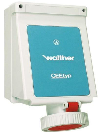
Walther Werke Wandsteckdose 63A 4P 400V 6h IP67 168406 Ausführung Aufputz, IEC-Stromstärke 63A, UL/CSA-Stromstärke (wenn UL-Ausführung gewünscht) 60A, Polzahl 4, Spannung nach EN 60309-2 400 V (50+60 Hz) rot, Uhrzeit-Stellung 6h, Kennfarbe rot, RAL-Nummer 3000, Schutzart (IP) IP67, Anschlussstechnik Schraubklemme, Kabeleinführung sonstige, Werkstoff Kunststoff, Befestigungsart innenliegende Befestigung, Isolierter Einbau, Wandsteckdose 63A 4P 400V 6h IP67 Innenbefestigung 2 Kabeleinf.
