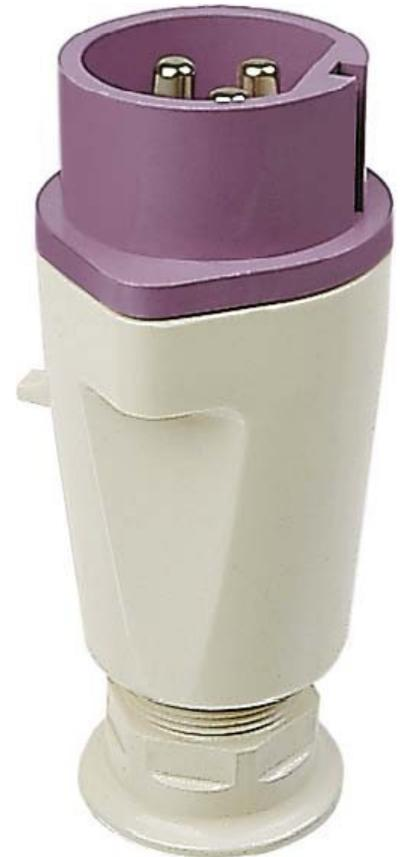
Walther Werke NORVO Stecker 32A 2P 42V 11h IP44 11225 IEC-Stromstärke 32A, UL/CSA-Stromstärke (wenn UL-Ausführung gewünscht) 30A, Polzahl 2, Spannung nach EN 60309-2 20-25 V / 40-50 V (>400-500 Hz) grün, Uhrzeit-Stellung 11h, Kennfarbe grün, RAL-Nummer 6025, Schutzart (IP) IP44, Anschlussstechnik Schraubklemme, Kabeleinführung Verschraubung, Steckrichtung gerade, Werkstoff Kunststoff, NORVO Stecker 32A 2P 42V 11h IP44 mit Trompeten- verschraubung
