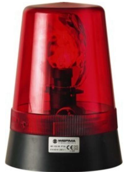
Werma Drehspiegelleuchte 48V AC/DC rt 881.152.56 Nennspannung 48V, Stromart AC/DC, Stromaufnahme 1A, Leistung 40W, Schutzart (IP) IP54, Kalottenfarbe rot, Fassung E14, Leuchtmittel Glühlampe, Optik Spiegel, Preiswerte Drehspiegelleuchte mit Glühlampe
