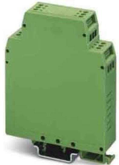
Phoenix Contact Elektronikgehäuse UEGH 42,5/1-SMD Breite 42,5mm, Höhe 106,7mm, Tiefe 79mm, Werkstoff Kunststoff, Farbe grün, Rastermaß (TE) 0,005, Betriebstemperatur -40 ...
