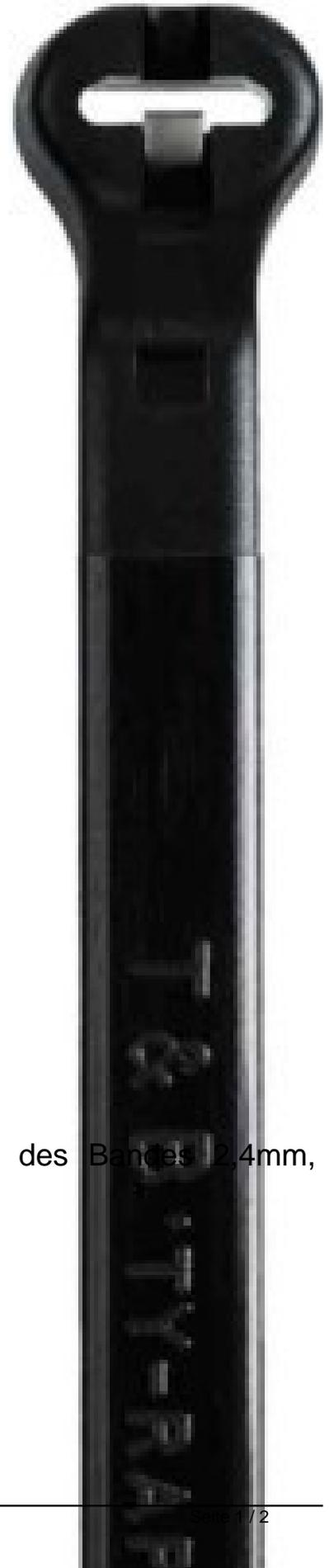
85°C, Ausführung ohne Verzahnung, Bandverschluss Stahlnase, Werkstoff Kunststoff, Werkstoffgüte Polyamid PA, Oberfläche unbehandelt, Halogenfrei, Farbe schwarz, Beschriftungsfläche ohne, Befestigungsart ohne, MIL-Zulassung, UL-Zulassung, Kabelbinder mit Stahlnasenverschluss, Standard, 92x2.4 mm, 80N, schwarz, PA 6.6
