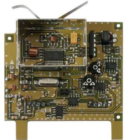
Wisi Pilot-Detektor 615,25-703,25 MHz VX58 0703 Anschlussart sonstige, VX 58 0703 - Pilot-Detektor 615,25-703,25 MHz für Verstärker der VX5..-Serie
