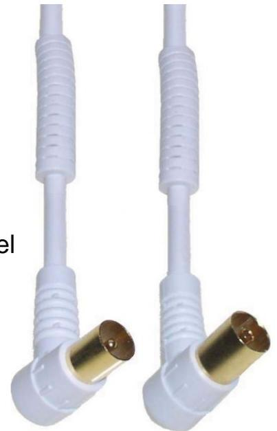
E+P Elektrik Winkelanschlusskabel ws 10m HFW210G Länge 10m, Farbe weiß, Ausführung Anschluss 1 Winkelstecker, Ausführung Anschluss 2 Winkelbuchse, Koax-Winkelstecker + Koax-Winkelkupplung, mit vergoldeten Kontakten und Ferritkernen an beiden Enden, digitaltauglich, dreifach geschirmt.
