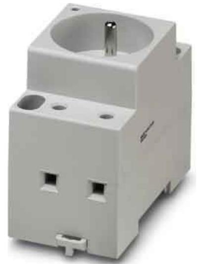
Phoenix Contact Steckdoseneinsatz VS-SI-SD-FR Bemessungsspannung 250V, Bemessungsstrom 16A, Spannungsart AC, Ausführung SCHUKO, Breite in Teilungseinheiten 2,5, Einbautiefe 68mm, Schutzart (IP) IP20,
